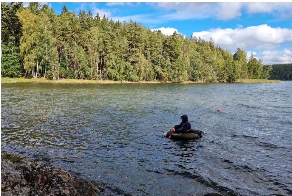
Figur 12. Viken lodades med hjälp av portabelt ekolod från flytring och bojar placerades ut för att markera revets sträckning.
