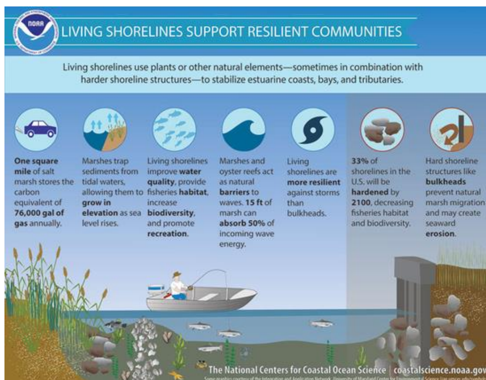
Figur 6. Schematisk bild av levande strandlinje, till vänster, respektive strandlinje med erosionsskydd i form av en mer traditionell strandskoning, till höger. Bild: National Oceanic and Atmospheric Administration (NOAA).
